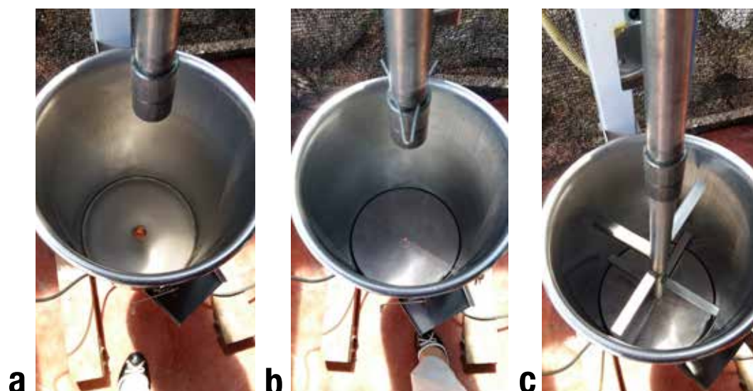
Figura 16. Despulpadora vertical por lotes para frutos de palma. a. tanque cilíndrico, b. tamiz y c. eje interno con seis aspas
